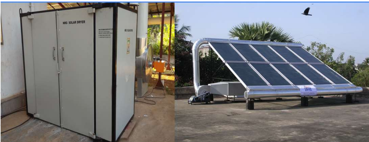
شکل ۲۵- خشک کن خورشیدی با ظرفیت ۱۰۰۰ کیلوگرم میوه تر
