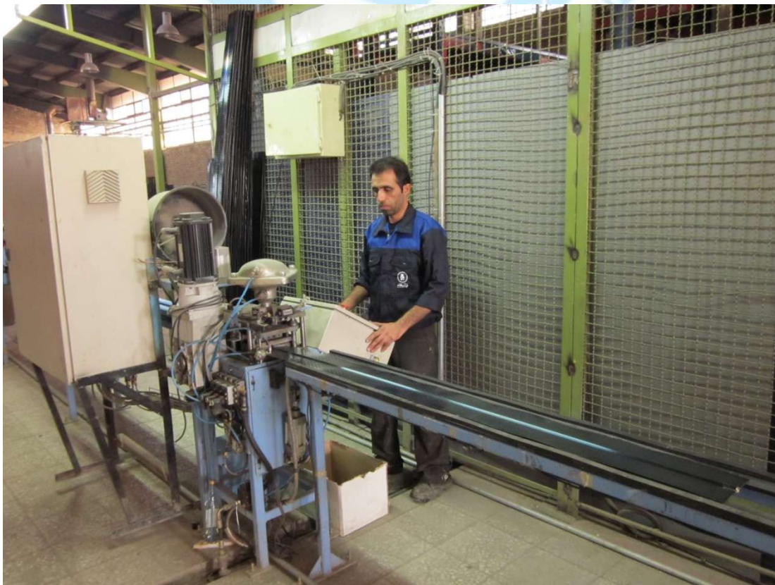
شکل ۸- خط تولید صفحه جاذب فراسا بعد از پوشش دهی - عملیات اتصال لوله مسی
