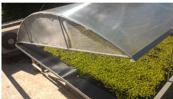
شکل ۲۲- خشک کن خورشیدی تونلی
