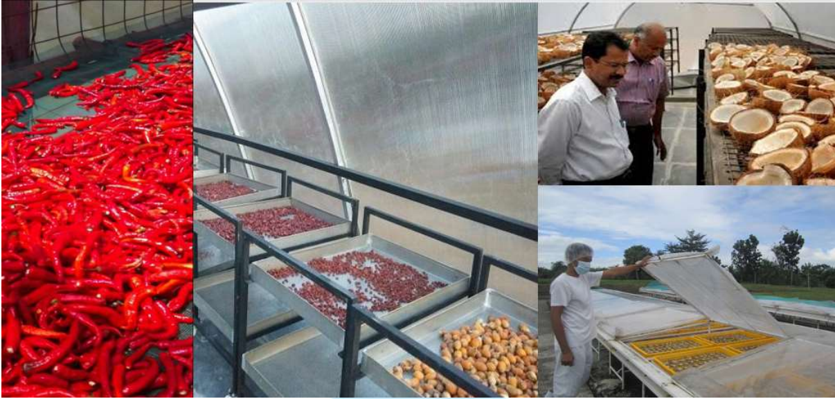
شکل ۲۳- خشک کن خورشیدی مدل گلخانه ای Tent&Tunel
