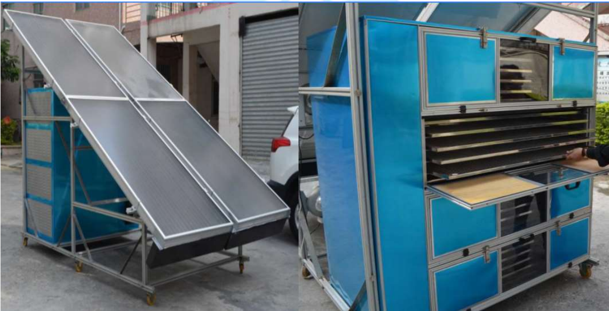
شکل ۲۴- خشک کن خورشیدی هوای گرم -خانگی با ظرفیت ۱۸۰ کیلوگرم میوه تر و قابلیت جابجایی
